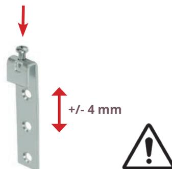
Utilisez la vis de réglage afin de mettre la colonne de niveau. **Il est important que les côtés soient parfaitement d'aplomb et qu'elle soit de niveau** (aidez-vous d'un niveau à bulle).
