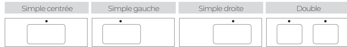
Plan vasque en profondeur avec trop-plein intégré à la céramique. 46,5 cm
