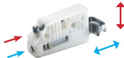
Utilisez les deux vis de réglage afin de mettre le caisson de niveau, puis verrouiller le contre le mur. **Il est important que les côtés soient parfaitement d'aplomb et que le plan soit de niveau** (aidez-vous d'un niveau à bulle).
